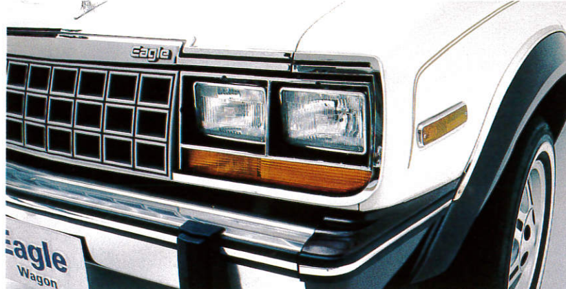
ヘッドランプ／角形4灯式ヘッドランプ。オフロード走行にも充分な耐久性を示します。
