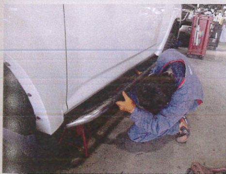
整備や修理といったことに加え、ワンオフパーツの製作やカスタマイズも実施している。取材時には落合モータースの4代目が、4ランナーのサイドステップをワンオフで製作中だった。
